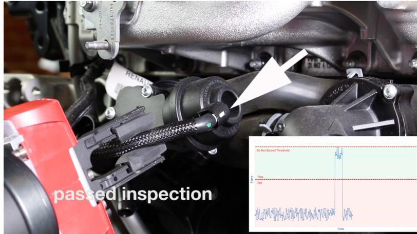
Si el cable se extrae (no detecta una resistencia de fuerza), no pasa la inspección.
