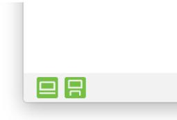
Estos íconos situados en el ángulo inferior izquierdo de la pantalla permiten ver si el software de Intera de su computadora está conectado a un robot Sawyer.
